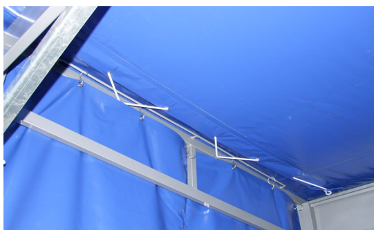
Fixation bâche toit
