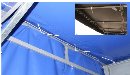
Fixation bâche toit sur le pourtour de la toiture
